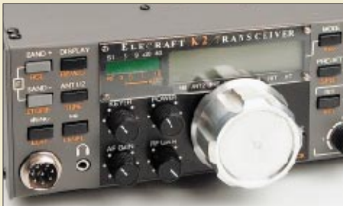
K2 – der QRP-Bausatz der Superlative; besonders hervorzuheben ist die europäischen Verhältnissen angepaßte Großsignalfestigkeit des Empfänger-eingangsteils
