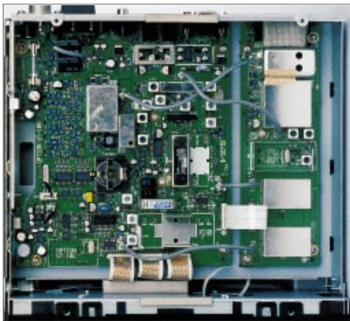
Bild 4: Die Innenansicht des IC-R75 macht dank SMD einen sehr aufgeräumten Eindruck. Deutlich sind die Steckplätze für die nachzurüstenden Optionen sowie für die beiden zusätzlichen ZF-Filter zu erkennen.
