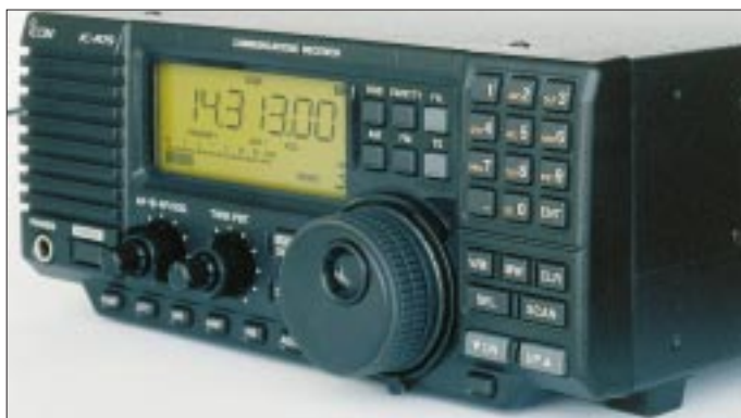
Bild 1: Das hintergrundbeleuchtete Display informiert mit Hilfe von angenehm großen Ziffern (15 mm hoch) über die aktuelle Empfangsfrequenz (bis zu 1 Hz genau) sowie zahlreiche weitere Parameter. Alternativ läßt sich die aktuelle Uhrzeit darstellen.
