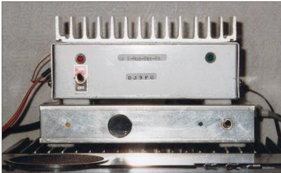
Bild 1: Mustergerät des Verfassers mit 1 x IRF610 im Teko-Gehäuse, darunter der Transverter 28/50 MHz
