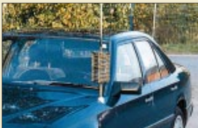
Etwas voluminös, dafür aber DX-tauglich ist diese Spule für die Mobilantenne des Verfassers. Sie stellt die Quintessenz aus lang-jährigen Experimenten dar.
