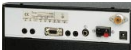
Bild 2: Rückansicht des Gerätes; auffallend der zweite Antenneneingang (500 Ω, Klemmbuchse) sowie RS-232C-Schnittstelle
