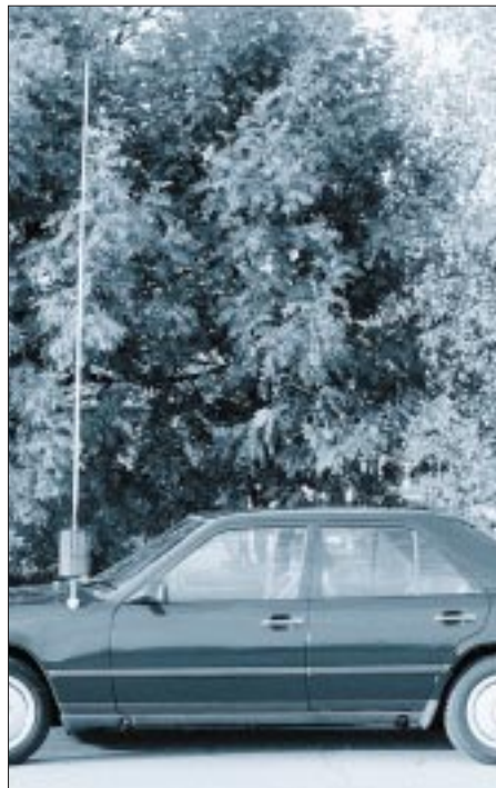
Bild 6: Mobilantenne mit „full-size“-Spule am Wagen des Verfassers Fotos: DL9AH
