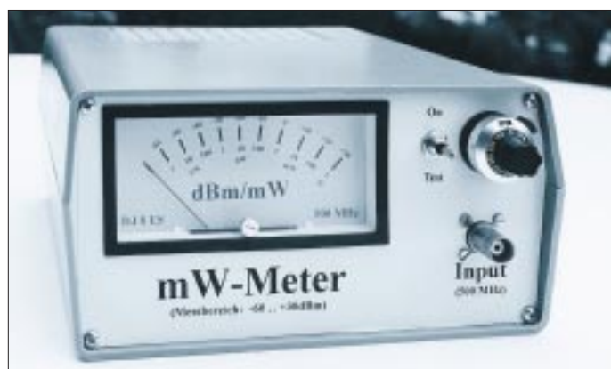
Bild 1: Frontansicht des Milliwattmeters mit Analoganzeige; rechts oben ist das Wendelpoti zu erkennen, das zur Frequenzgangkompensation dient.
